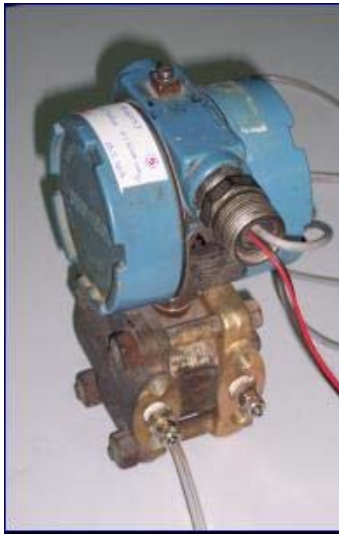
Figura 2.11 – Vista e sezione di un trasduttore capacitivo
